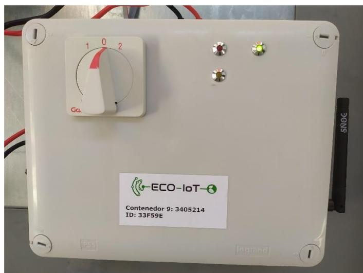
**Figura 10:** Caja con electrónica de control definitiva
